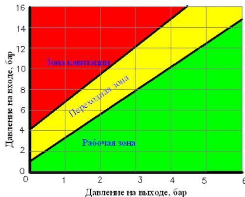
В случае нарушения этого условия редуктор будет шуметь, и седло клапана будет подвергаться кавитационному разрушению.
