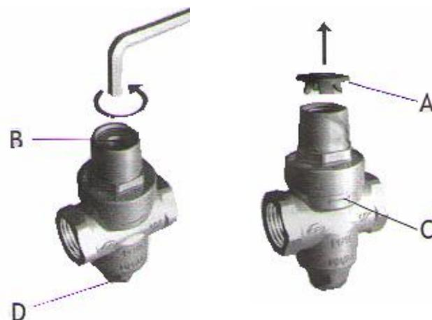
6.5. Настройка редуктора производится при расходе, близком к нулевому, но не нулевом. Это значит, что все водоразборные краны системы должны быть закрыты, а на одном из приборов оставлен минимально возможный струйный расход (расход, при котором выходящая из излива струя не разделяется на отдельные капли).
